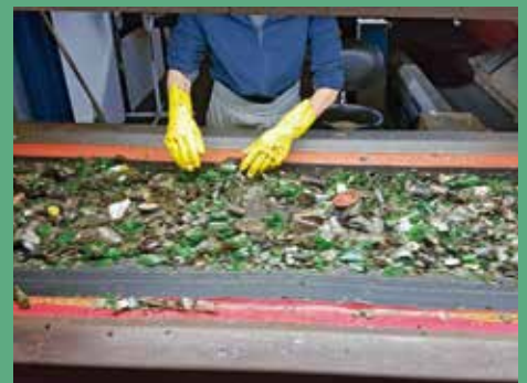
Störstoffe, wie Flaschendeckel, Fensterglas oder Keramik, werden aussortiert (Foto © GRL)
