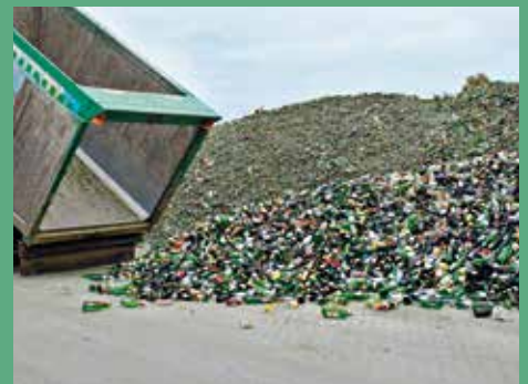
Das Altglas wird mit dem LKW – nach Farben sortiert – angeliefert
